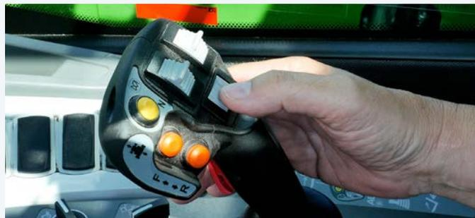
Eins der Sicherheitssysteme ist die Überlastabschaltung. Im Notfall lässt sie sich kurzfristig über einen Kabinenschalter unterbrechen, um die Maschine und den Fahrer aus Gefahrensituationen befreien zu können. Zudem lassen sich für die Straßenfahrt ebenfalls via Kabinenschalter alle Funktionen der Arbeitshydraulik deaktivieren.
